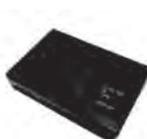
加速度 / 角速度センサより、姿勢推定情報を内部演算。クォータニオン形式で無線送信およびメモリ保存可能。リアルタイムな角度算出から、全身動作分析など、用途多数。
