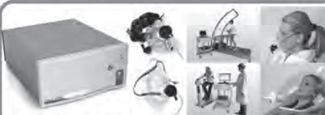
ブレスバイブレスとミキシングチャンバ(オプション)に対応。安静時代謝から最大酸素摂取量まで簡単に高精度な測定。各社の自転車エルゴメータ、トレッドミルに対応。
