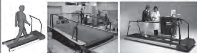
一般的な訓練や負荷試験のためのトレッドミルからダブルベルト、床反力センサ内蔵、大型、超高速など特殊仕様に対応した各種計測用トレッドミル。
