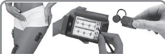
最新のワイヤレス筋電計。ケーブルレスに少ない拘束での測定と、高品質な筋電図の取得、測定準備の時間と手間の節約が可能。プローブ内蔵メモリにより通信障害でもデータの損失なし。開発者向けSDKあり。
